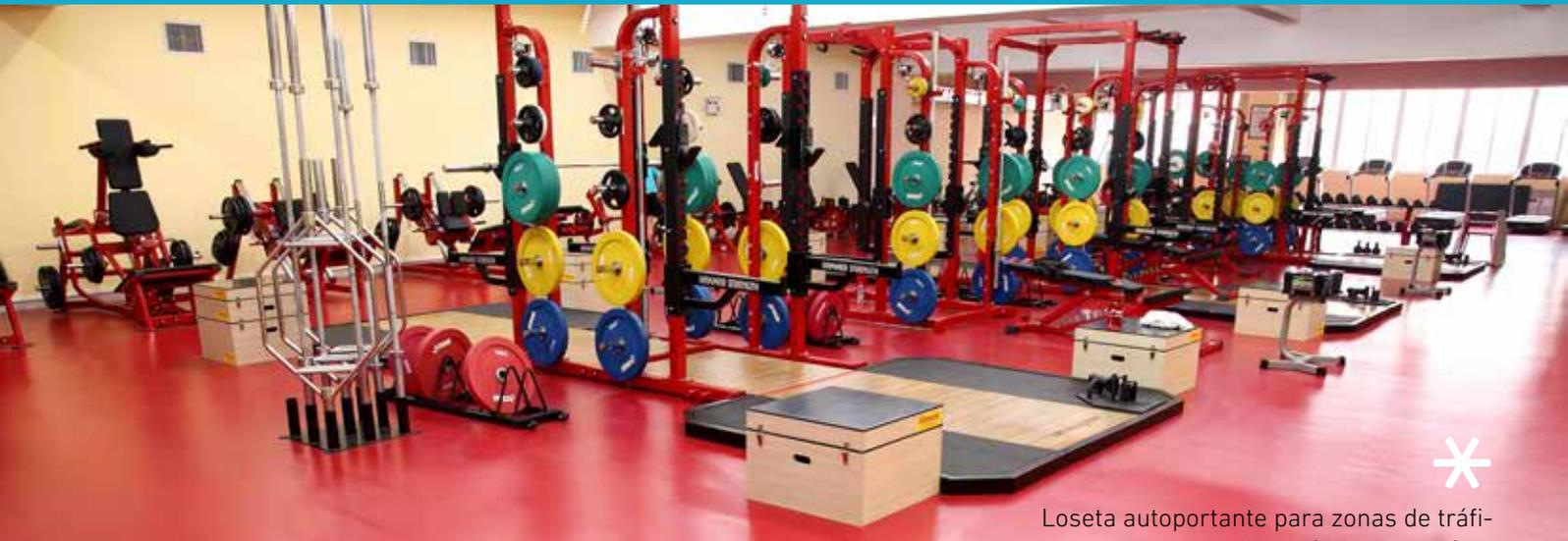
*Las zonas de peso libre precisan un pavimento con resistencia a grandes cargas estáticas y al punzonamiento, sin descuidar la capacidad de absorber impactos puntuales de gran peso, manteniendo un confort acústico uniforme.*
